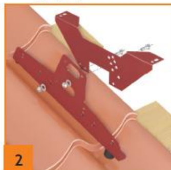
Монтаж кронштейна регулирующего
