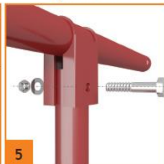
Монтаж скобообразного кронштейна
