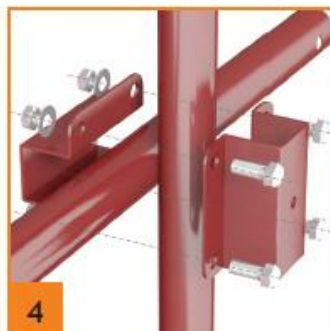
Монтаж шляпного кронштейна
