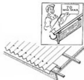
Универсальный карнизный короб может использоваться для лучшей гидроизоляции карниза кровли. Максимальный свес листа Ондулин на карнизе — 70 мм.
