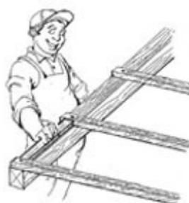
Бруски обрешетки должны быть прибиты к стропилам на правильных расстояниях по осям. Пользуйтесь деревянным "интервалом" для поддержания параллельности обрешетин к карнизу.
