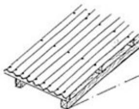
При угле наклона крыши от  $15^\circ$  и более (уклон от 1/4 и менее) делается обрешетка с интервалом 600 мм по осям. Концевой нахлест: 170 мм, боковой нахлест: 1 волна.
