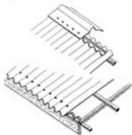
Заполнитель карниза Ондулин используйте для закрытия просвета листа на карнизе, а также для закрытия просвета между коньковым элементом и листом Ондулин. Заполнитель карниза может применяться или не применяться в зависимости от условий вентиляции каждой конкретной кровли.
